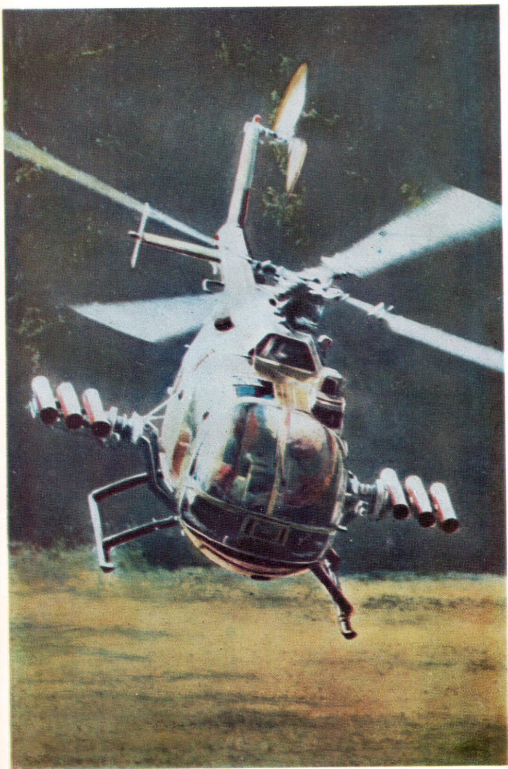
ЗАПАДНОГЕРМАНСКИЙ ПРОТИВОТАНКОВЫЙ ВЕРТОЛЕТ BO-105P. Основные тактико-технические характеристики: максимальный взлетный вес 2300 кг, вес пустого 1120 кг, максимальная скорость полета 270 км/ч, крейсерская 230 км/ч, максимальная дальность 600 км, радиус действия 230 км. Вооружение — шесть ПТУР «Хот» (дальность стрельбы до 4000 м, управление ракетами по проводам), имеется лазерный дальномер и гиросtabilизированный оптический прицел. Этими машинами оснащены полки противотанковых вертолетов армейских корпусов ФРГ
